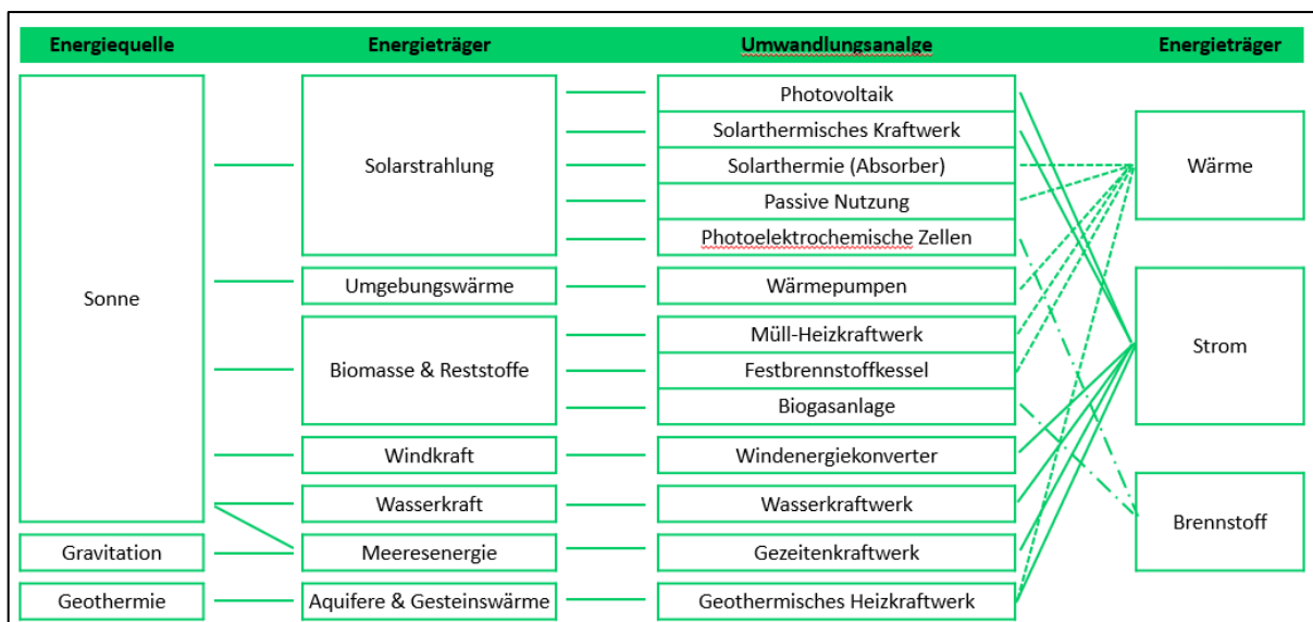
Abbildung 6-3: Erneuerbare Energien von der Quelle zum Energieträger in Anlehnung an WAGNER, ROUVEL & SCHÄFER 1999
